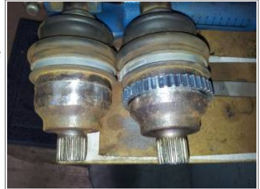
Erneuern des ABS-Rings auf die Welle
