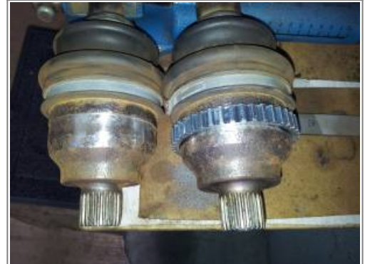
Erneuern des ABS-Rings auf die Welle
