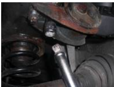
linkes Motorlager (Fahrerseite; zwei Schrauben mit E14)
