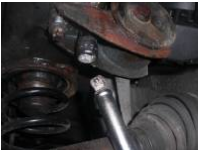
linkes Motorlager (Fahrerseite; zwei E14 Schrauben)
