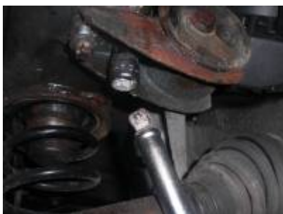
linkes Motorlager (Fahrerseite; zwei E14 Schrauben)
