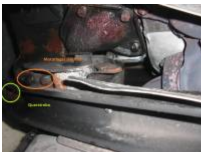
rechtes Motorlager (14 Schrauben) und Querstrebe
