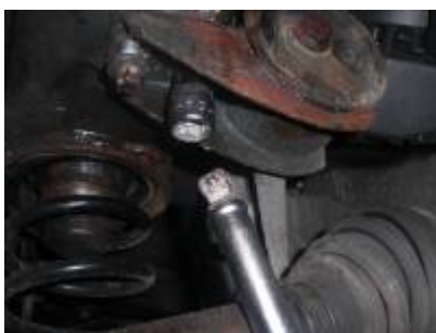
linkes Motorlager (Fahrerseite; zwei E14 Schrauben)
