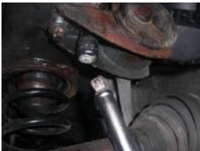
linkes Motorlager (Fahrerseite; zwei E14 Schrauben)
