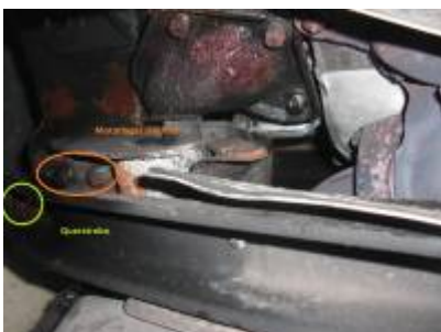
rechtes Motorlager (14 Schrauben) und Querstrebe
