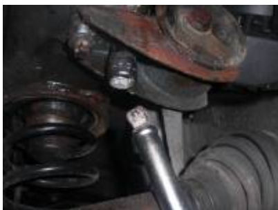
linkes Motorlager (Fahrerseite; zwei Schrauben mit E14)
