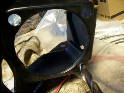
4. neuen Scheinwerfer einbauen und schauen das die Nasen richtig einrasten
