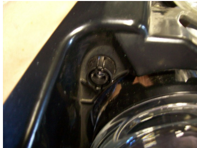
4. neuen Scheinwerfer einbauen und schauen das die Nasen richtig einrasten
