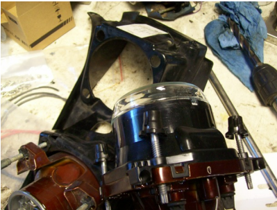
4. neuen Scheinwerfer einbauen und schauen das die Nasen richtig einrasten
