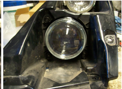
4. neuen Scheinwerfer einbauen und schauen das die Nasen richtig einrasten
