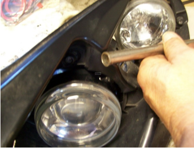
3. Löcher auf 14mm auf bohren
